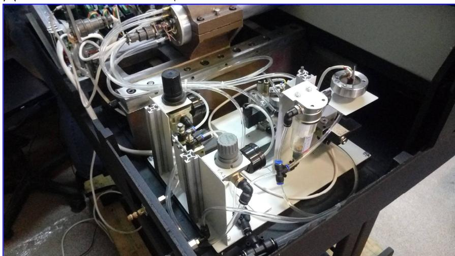
Новая панель с водо и пневмовакуумным оборудованием изготовлена на основе современных клапанов, фитингов, отстойников, фильтров и т.д.
