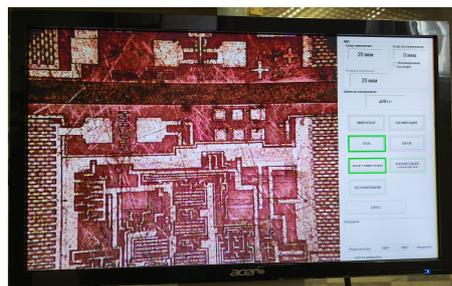
Возможна замена **микроскопа на новый монокуляр** с панкратической системой и видеокамерой – позволяет вывести четкое, цветное изображение на монитор.
