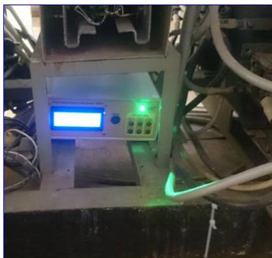
БУН - современные блоки с цифровым управлением. Поддержание температуры с точностью до 0.3 градусов Цельсия. БУН имеет самотестирование, контролирует наличие связи с персональным компьютером и модулем ввода с термопары – безопасно остановит работу в случае зависания компьютера или выхода из строя модуля ввода с термопар. Распознает обрыв термопары и контролирует перегрев по внутренней уставке.
