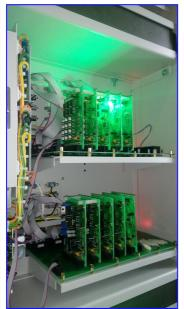
СУ газовакуумным оборудованием установок «**ASM**» располагается на месте старых блоков управления и обеспечивает сбор данных с датчиков и управление всеми РРГ, насосами, затворами, клапанами и т.д. Связь с контроллером канала осуществляется посредством промышленного интерфейса RS-485
