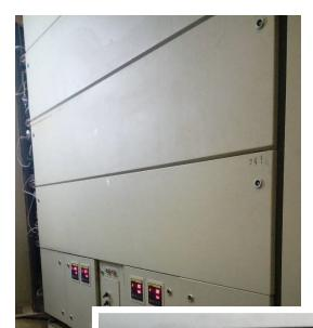
Система нагрева обеспечивает работу с 5-ти точечной термопарой в реакторе и пятью термопарами в нагревателе.
