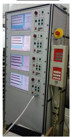
Новая стойка управления включает в себя четыре компьютера с сенсорными мониторами для независимого управления каждым каналом.
