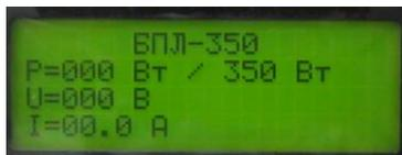
7. Нажать кнопку **«ВКЛ.»** на лицевой панели блока. Светодиод кнопки **«ВКЛ.»** начнет моргать и через несколько секунд загорится – индицируя готовность блока к поджигу лампы ДРШ-350.
