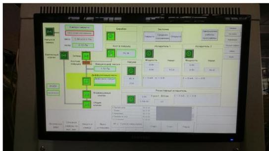
ПО СИСТЕМЫ УПРАВЛЕНИЯ УСТАНОВКОЙ обеспечивает управление всем технологическим циклом работы установки, обеспечивает постоянный контроль работоспособности модулей и блоков, включает в себя тестовые и наладочные компоненты.
