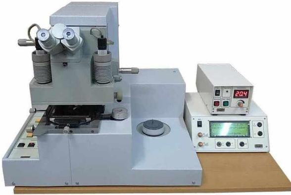
Установка контактной фотолитографии с ручной загрузкой пластин. Позволяет работать как с целыми пластинами, так и с кусочками пластин.
